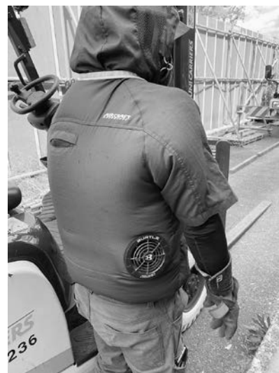
送風ファン付き作業着の様子
